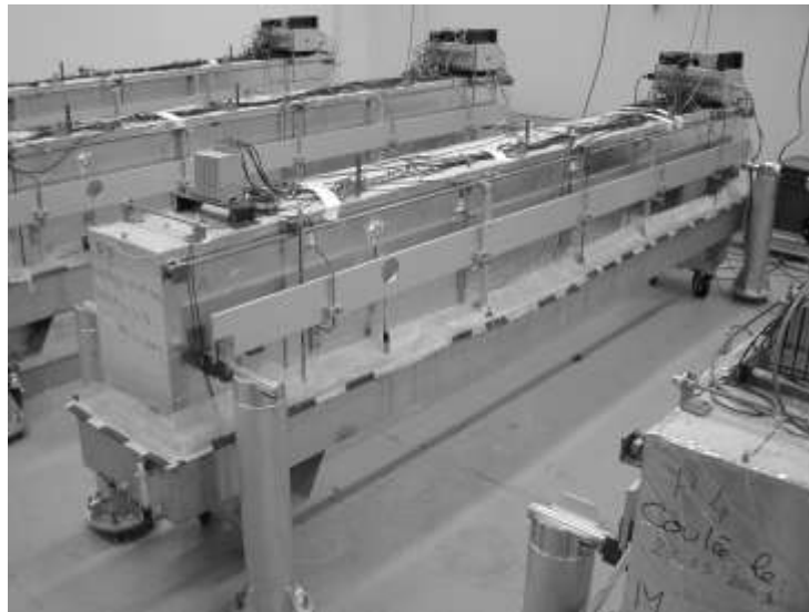
Figure 1 : Poutres sous gradient hydrique
